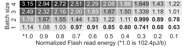
图 6. Llama 4 到 Llama 3.3 的每标记能量消耗比关于批处理大小和闪存读取能量。SSD 通过 NVLink5.0 与 GPU 相互连接。
