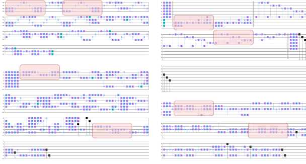
图 3. 量子电路中门分布模式的可视化。粉红色突出显示的区域表示量子操作集中的区域，展示了重复出现的门模式以及各个量子位上的非均匀门分布。这种自然形成的量子操作聚类表明了通过模式感知编译进行电路优化的机会。
